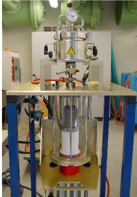
Abb. 9: Knetgefäß verbunden mit Giessglocke. MBK befindet sich in der Glocke.
