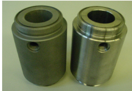
Abb. 3: links MBK sandgestrahlt, rechts MBK glatt
