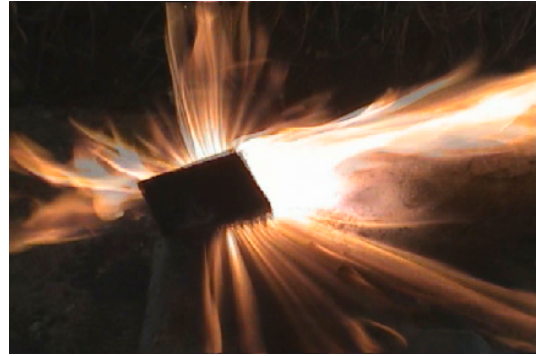
Abb. 15: erfolgreicher Anzündversuch mit einer Zündkapsel
